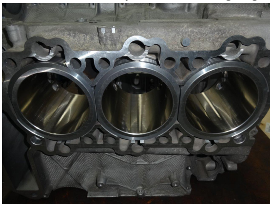
Abb. 74: Zum Vergleich die oberen Ringe nach Umbau auf „Closed-Deck“
