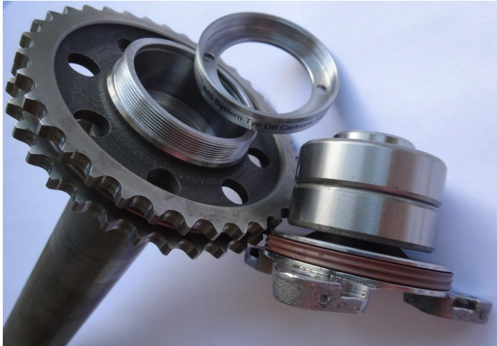
Bild 39: Der aufwändige Cartronic Doppellager-Kit Typ M.96/DB für Zwischenwelle M.96 (bis MJ 2000 ). Das „Lagerpaket“ wird durch eine Überwurfmutter gesichert. Das Wellenende verfügt über ein Außengewinde, die Ritzel sind nachträglich verstiftet und der Lagerdeckel wurde modifiziert. Der Lagersitz wurde nachgearbeitet. Diese Arbeiten sind nur im Hause Cartronic möglich.
