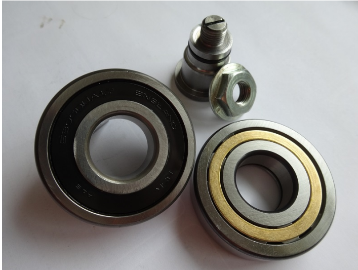
Bild 41: Cartronic Zwischenwellenlager-Kit "großes Lager" ab MJ 2007. Der massive Spannbolzen wird weiterverwendet. Links das Serienlager (geschlossen), Rechts das verstärkte und offene Speziallager mit Messingkäfig.
