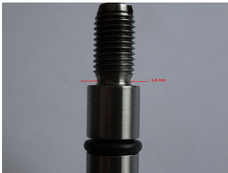
Bild 37: Zu schwach ausgelegter 10 mm Serien-Spannbolzen aller Zwischenwellenlager von 1996-2006 / Gewinde M8
