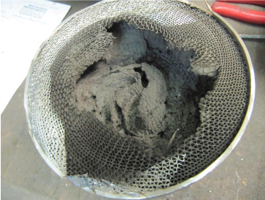
Bild 6: Ein durch einen Brennraumschaden verursachter Katalysatorschaden. Der Metallträger ist zum Teil geschmolzen.
