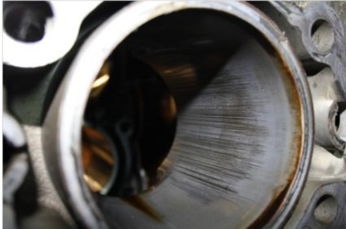
Bild 1: Zylinderlaufbahn mit typischen Fressspuren
