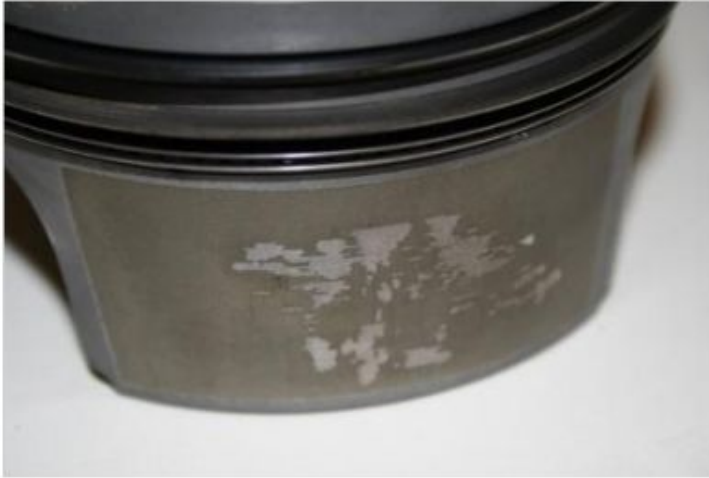
Bild 6: Teilweise beschädigte und partiell abgelöste Kolbenhemdbeschichtung
