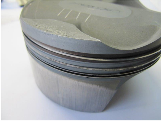
Bild 10: Auf dem Kolbenboden sieht man deutlich erkennbare Einschlagspuren. Dieser Kolben ist auf Grund seiner Konizität am Zylinderkopf angeschlagen. Dies macht sich durch „metallisch“ klingende, Klopfgeräusche bemerkbar. Aber nur, wenn der Motor auf Betriebstemperatur ist.
