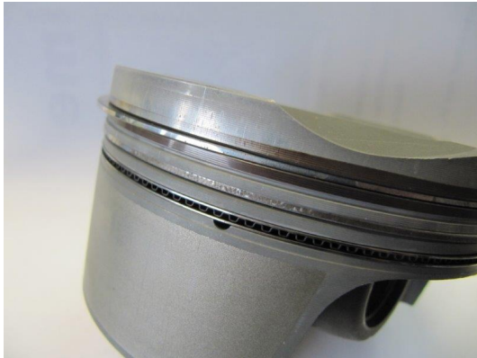
Bild 11: Zeigt die unbelastete Flanke (Kolbenhemd) von Kolben 4. Die seitliche Gleitschicht ist nahezu unbeschädigt. Aber der Bereich oberhalb des 1. Kolbenrings (glänzend) zeigt Abnutzungsspuren. Dort hat der Kolben die Lauffläche berührt (was nicht vorgesehen ist).
