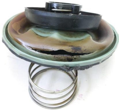
Bild 59: Deutlich sichtbar; die defekte Membrane
