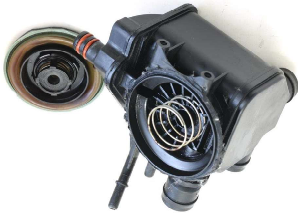
Bild 58: Geöffneter Separator (Ölabscheider)
