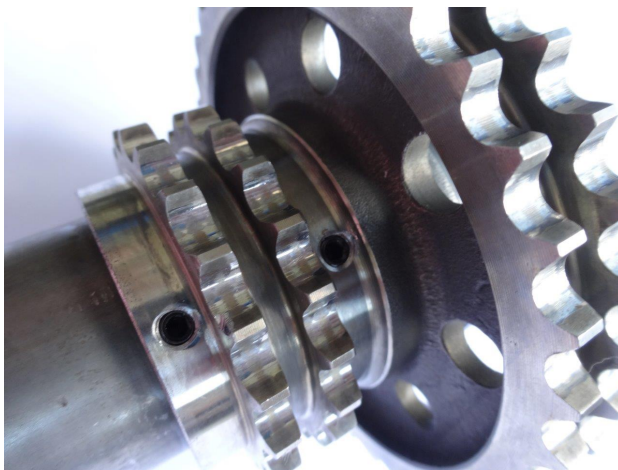
Bild 42: Zusätzliche Verstiftung der Kettenräder. Die ultimative Verdrehsicherung. „by Cartronic“
