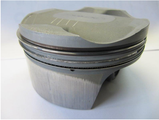
Bild 9: Zeigt das verschlissene, konische gewordene Kolbenhemd eines Kolbens von Zyl. 4. Im silbernen Bereich fehlen, von oben nach unten zunehmend, fast 1,0 mm Material, welches sich fein verteilt im Öl befindet. Ein derart beschädigter Kolben kontaminiert das Öl mit rund 150 mm 3 Aluminiumabrieb.
