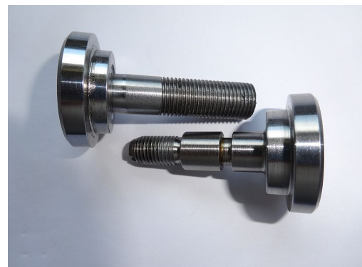
Bild 37: Zu schwach ausgelegter 10 mm Serien-Spannbolzen aller Zwischenwellenlager von 1996-2006 / Gewinde M8
