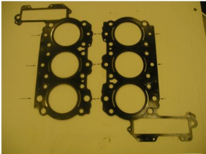
Bild 17: Bild der "alten", besseren und noch asymmetrisch aufgebauten Kopfdichtung
