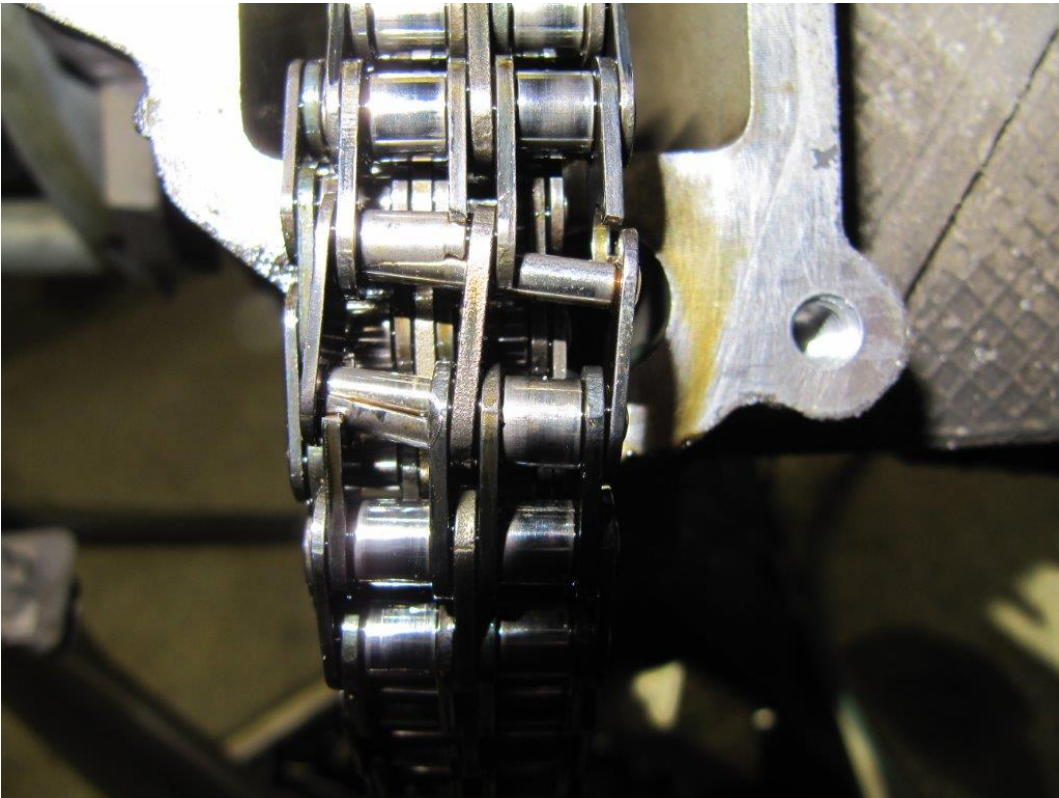
Bild 11: Eine teilweise gerissene Steuerkette als Ursache für den Schaden an den Kettenschienen auf Bild 10
