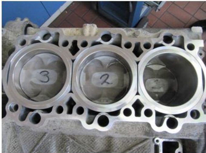
Bild 23: Ein von Cartronic Motorsport auf Closed-Deck modifizierter 3,8Ltr. Motor mit NiSiC Zylindern.
