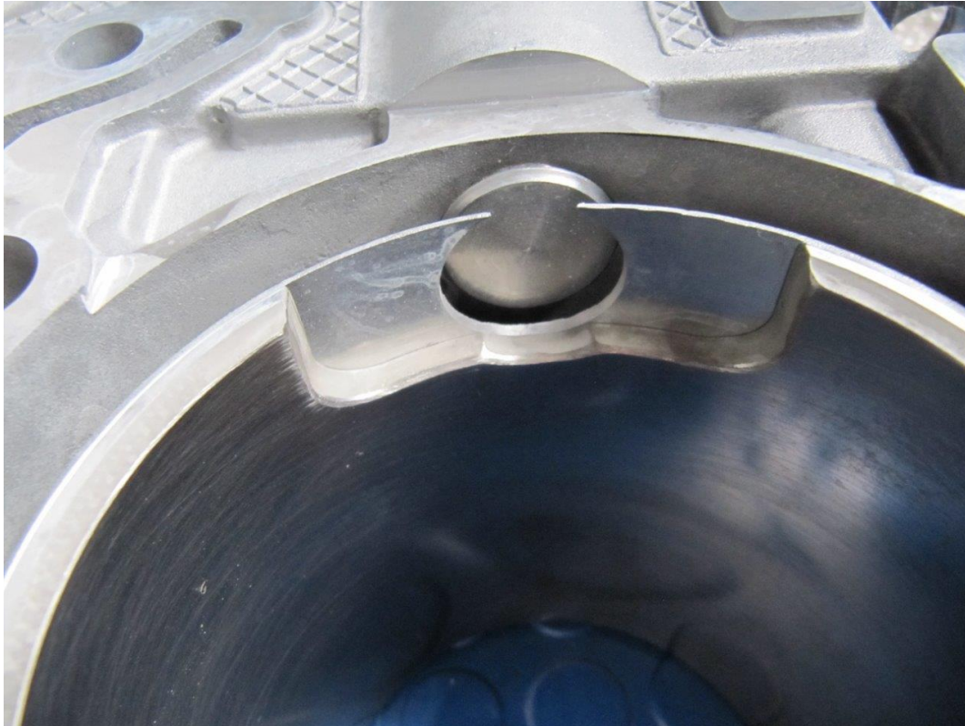
Bild 52: Eingepresster Schmiede-Zylinder der Generation 1. Nur 1,5 mm vom originalen Zylindermaterial verbleiben zur sicheren Führung und Aufnahme des neuen Zylinders.
