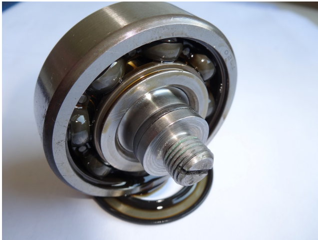
Bild 32: Originallager aus Zwischenwelle eines M97/X51 Motors. Lagerdeckel wurde entfernt. Nach 45.000 Km Laufleistung keine Fettfüllung mehr vorhanden. Zwar noch keine Späne, aber dafür nur eine geringe Mengen Motoröl. Ein potenzielles Problemlager!
