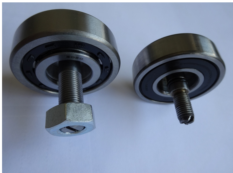
Bild 40: Cartronic Zwischenwellenlager-Kit einreihig (links) vs. Serie M.96 (ab MJ 2001-2006)
