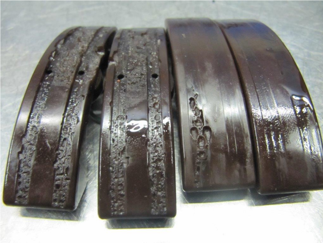
Bild 10: Total erodierte Kettenschienen
