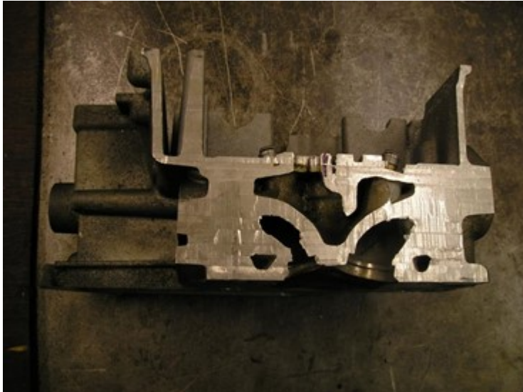
Bild 14: Querschnitt Zylinderkopf. Zeigt die Wasserkanäle
