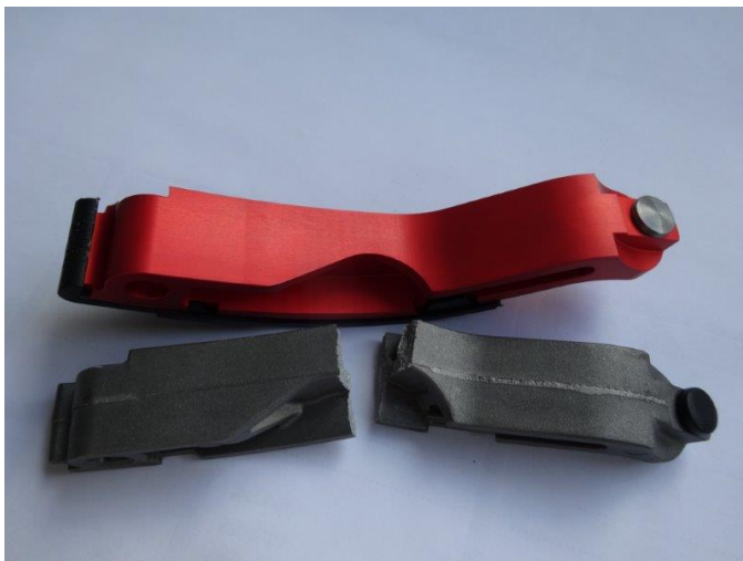
Bild 27: Gebrochene originale Kettenschiene (unten) sowie verstärkte Cartronic/Hartech Version (oben)
