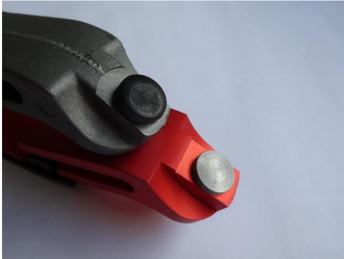
Bild 28: Original (oben) mit verschlissenem Kunststoffknopf, Verstärkte Version (unten) mit Stahlknopf.
