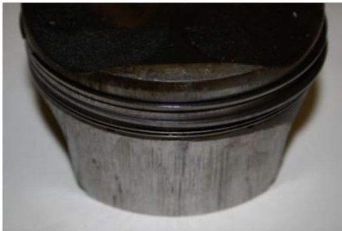
Bild 2: Dieser seitlich verschlissene und gefressene Kolben weist oben Bereiche auf, die den Kopf berührt haben.
