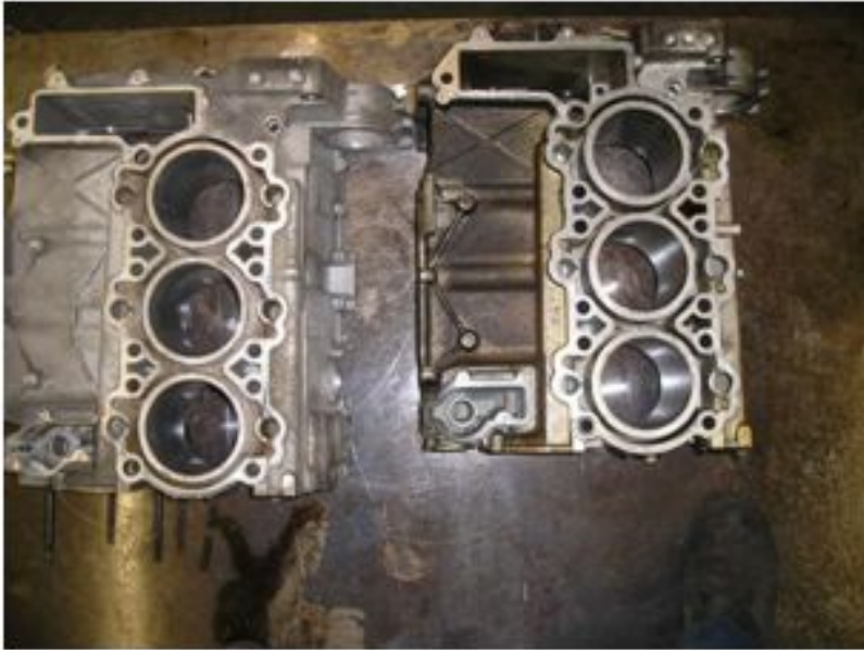
Bild 20: Oberseiten eines 3,2er Boxster S und eines 3,4er Motors in Open-Deck Konstruktion
