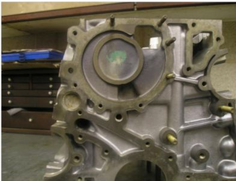
Bild 12: Motorblock eines Porsche 944 mit Flansch für Wasserpumpe
