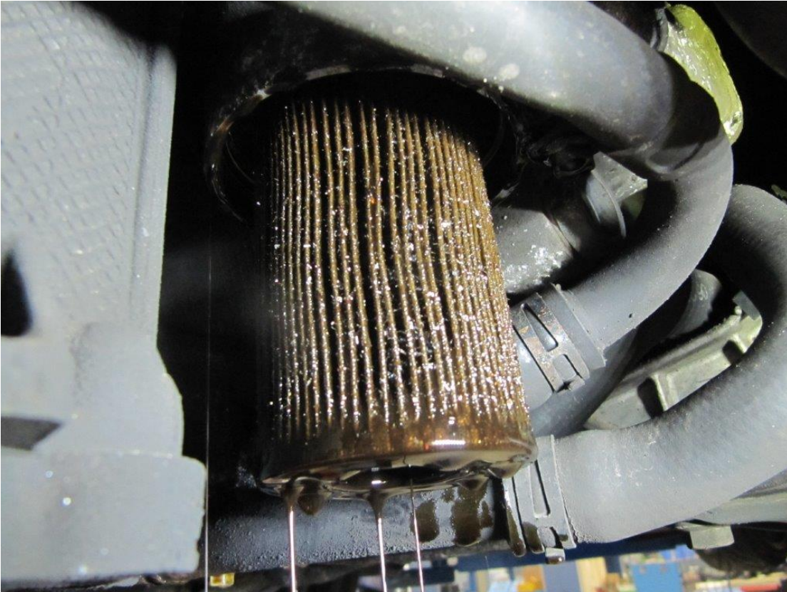
Bild 12: Metallspäne im Ölfilter
