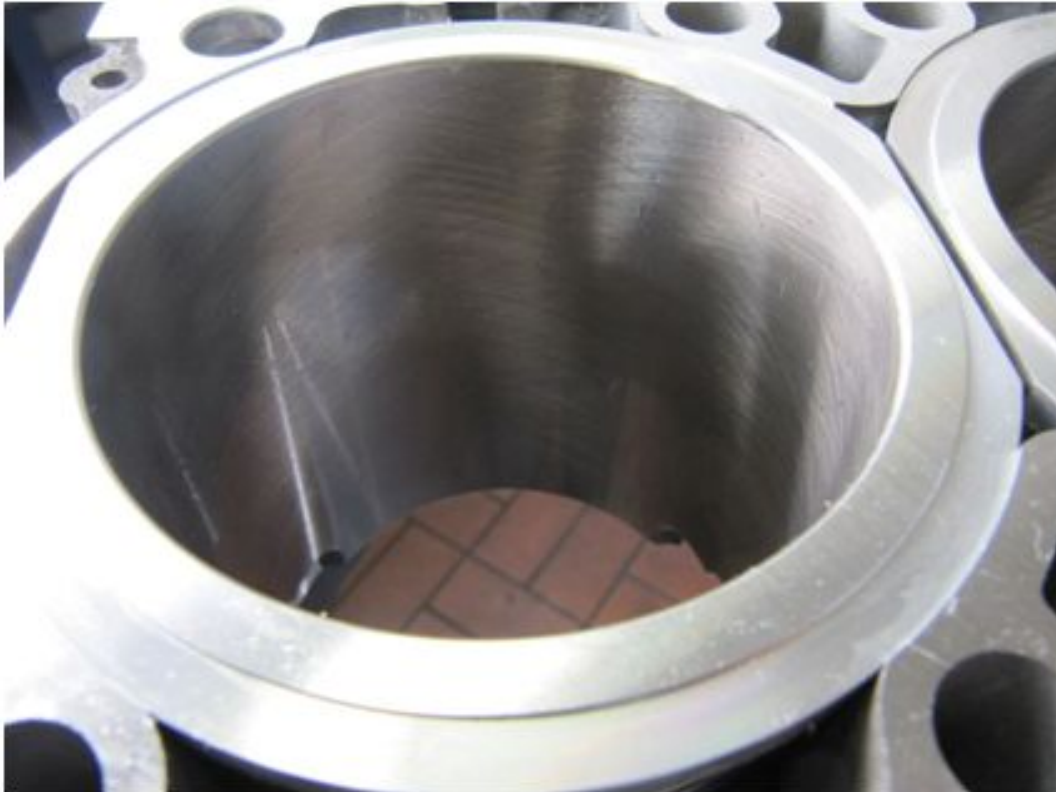
Bild 50: Von Cartronic eingebauter, fertig gehonter 3,8er Zylinder für einen 997 X51-Motor. Stabil, gut geführt, geschmiedet, NiSiC (Nikasil) beschichtet. Gebaut für eine lange Lebensdauer.
