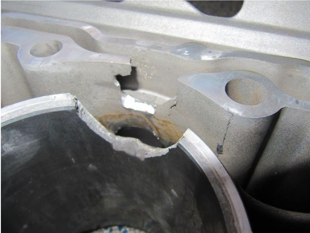
Bild 20: Pleuel trifft Zylinderwandung und Motorgehäuse
