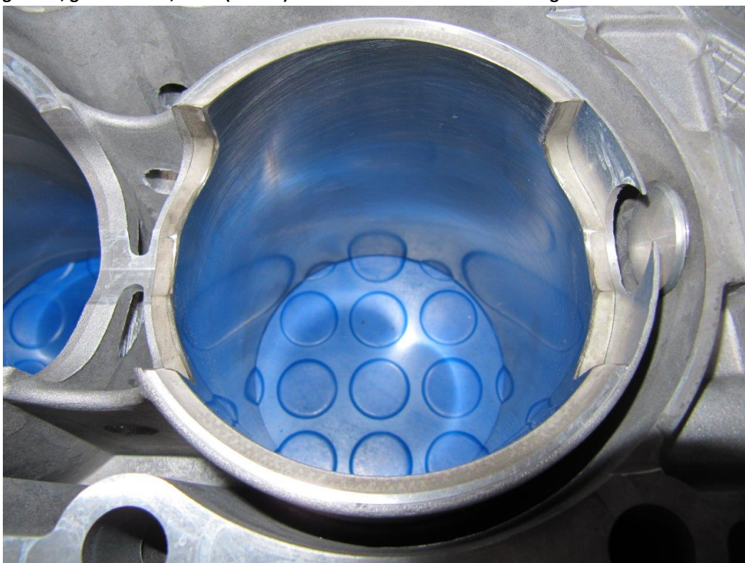
Bild 50: Von Cartronic eingebauter, fertig gehonter 3,8er Zylinder für einen 997 X51-Motor. Stabil, gut geführt, geschmiedet, NiSiC (Nikasil) beschichtet. Gebaut für eine lange Lebensdauer.
