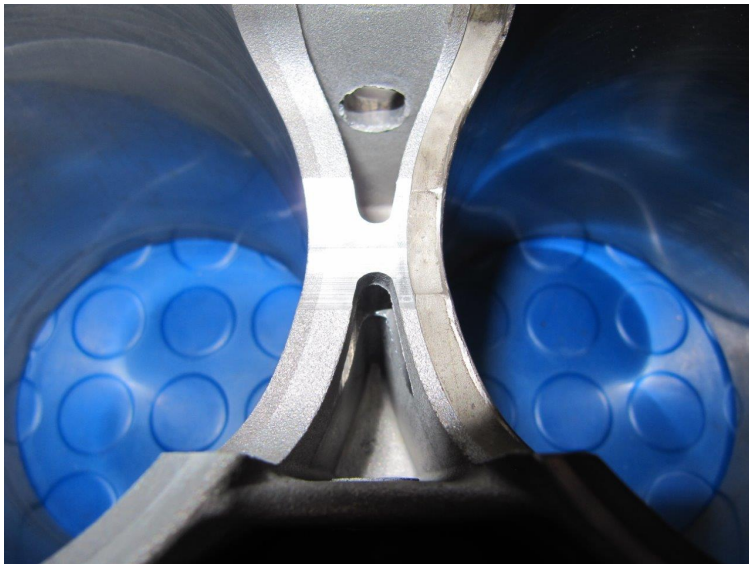
Bild 5: Rechts, ein neu eingeschrumpfter Schmiede-Zylinder. Links, ein Original Zylinder. Gut erkennt man den dunkleren Bereich der Lokasil®-Lauffläche der rund 1/3 der Materialstärke ausmacht. Aus diesem Bereich stammen die sich lösenden Silizium Partikeln.
