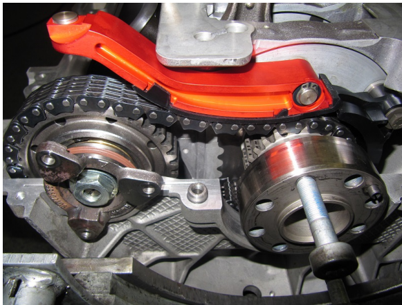
Bild 29: Verbaute Kettenschiene zwischen Kurbelwelle und Zwischenwelle
