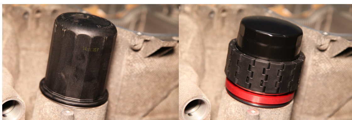
Foto 62: Links: Originales Kunststoffgehäuse für den Papierfilter – Rechts: installierter Upgrade-Kit
