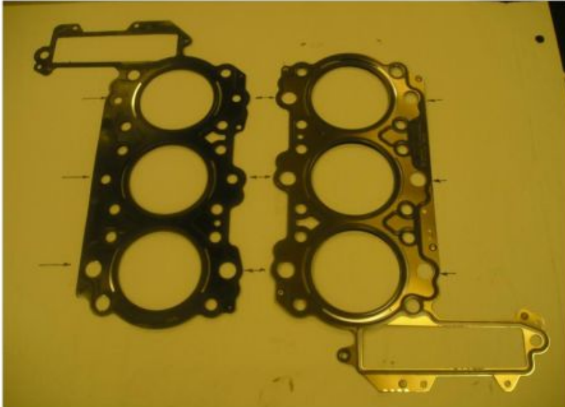
Bild 18: Rechts liegt die „neue“ Dichtung mit gleichgroßen Löchern. Links die „alte“.
