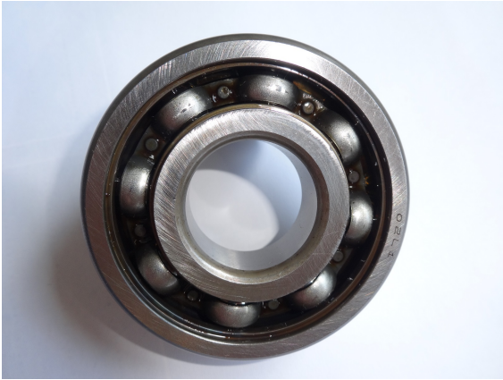
Bild 34: Zwischenwellenlager original - einreihig mit Stahlkäfig und 8 Kugeln, Lagerdeckel wurde nachträglich entfernt.
