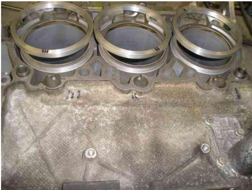
Bild 45: Unsere Verstärkungsringe, sichtbar und lose liegend am oberen Ende der Zylinder vor der Montage. Später befinden sich die Ringe direkt unter der Kopfdichtung und erzeugen einen Closed-Deck Motor.
