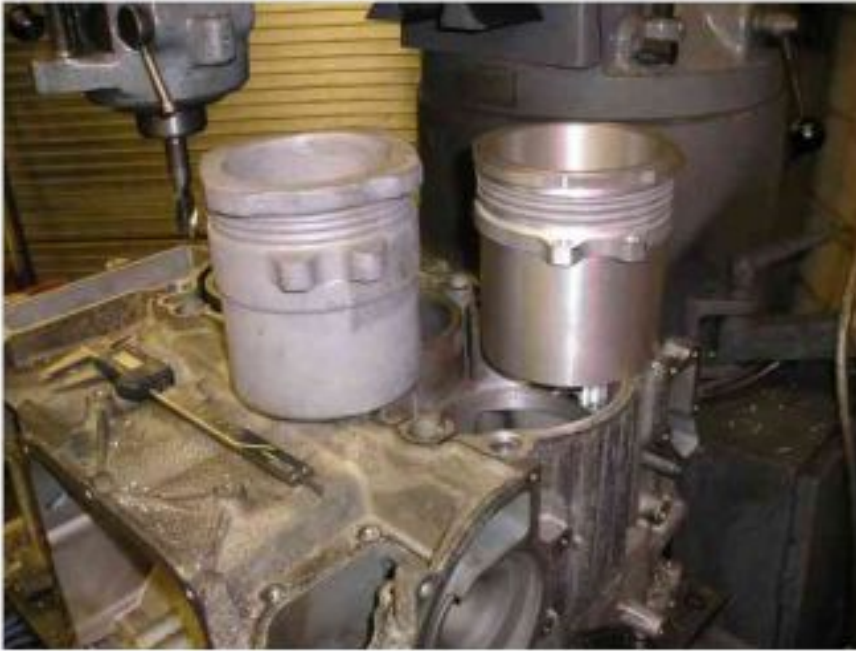
Bild 49: Zylinderrohling links und einbaufertiger mit Nikasil beschichteter Zylinder rechts
