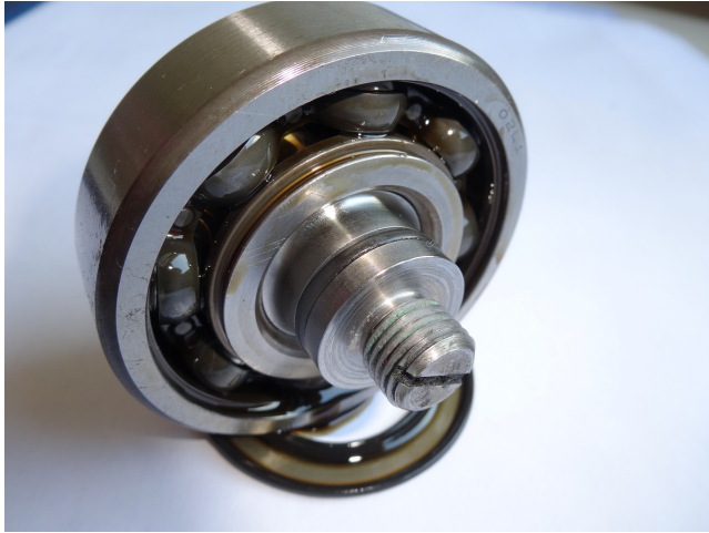
Bild 31: Originallager aus Zwischenwelle eines M97/X51 Motors. Lagerdeckel wurde entfernt. Nach 45.000 Km Laufleistung keine Fettfüllung mehr vorhanden. Zwar noch keine Späne, aber dafür nur eine geringe Mengen Motoröl. Ein potenzielles Problemlager!
