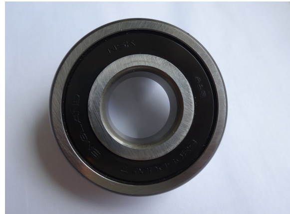
Bild 32: Zwischenwellenlager original, mit Lagerdeckel beidseitig und Fettfüllung
