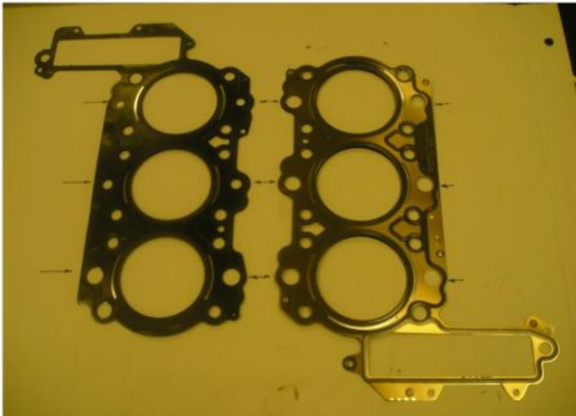
Bild 17: Rechts liegt die „neue“ Dichtung mit gleichgroßen Löchern. Links die „alte“.
