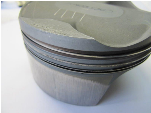
Bild 9: Auf dem Kolbenboden sieht man deutlich erkennbare Einschlagspuren. Dieser Kolben ist auf Grund seiner Konizität am Zylinderkopf angeschlagen. Dies macht sich durch „metallisch“ klingende, Klopfgeräusche bemerkbar. Aber nur, wenn der Motor auf Betriebstemperatur ist.
