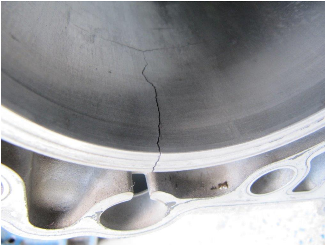
Bild 21: Gerissener Zylinder (im Bereich OT). Gegenüber liegt der Wasserkanal. Ob da wohl ein Zusammenhang besteht?
