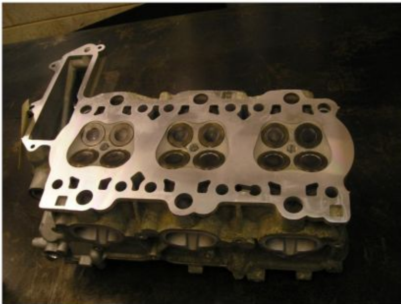
Bild 12: Zylinderkopf eines M.96 Wasserboxer Motors
