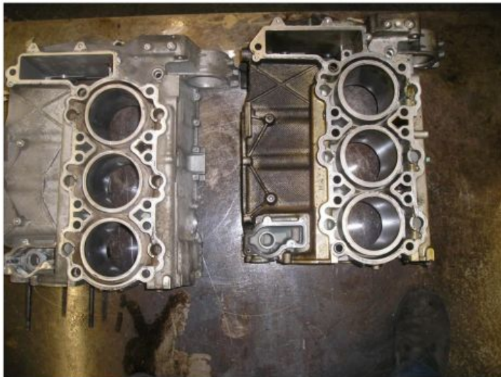
Bild 7: Identische Blockmaße für unterschiedliche Bohrungen. Auffallend die unterschiedlichen Kühlwasserräume rund um die Zylinder.
