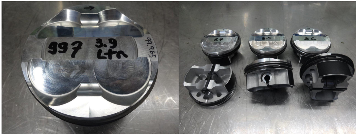
Abb. 71/72: Die Cartronic Spezialkolben für 3,7 ltr. und 3,9 ltr. Umbauten
