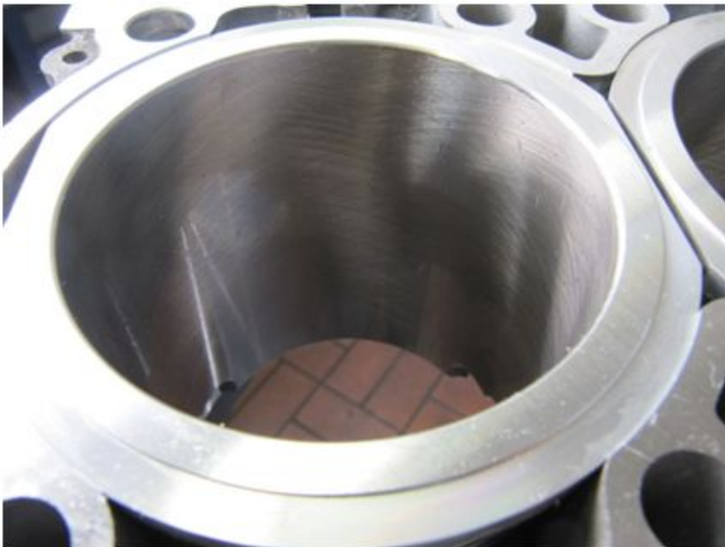
Bild 49: Von Cartronic eingebauter, fertig gehonter 3,8er Zylinder für einen 997 X51-Motor. Stabil, gut geführt, geschmiedet, NiSiC (Nikasil) beschichtet. Gebaut für eine lange Lebensdauer.
