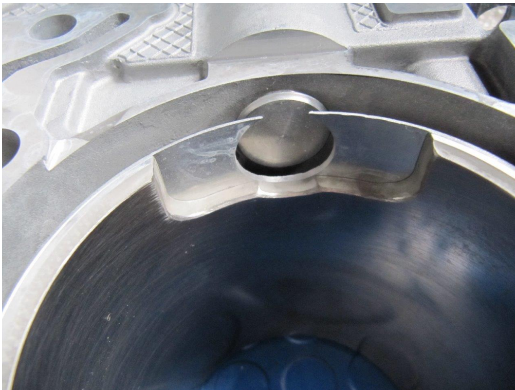
Bild 51: Eingepresster Schmiede-Zylinder der Generation 1. Nur 1,5 mm vom originalen Zylindermaterial verbleiben zur sicheren Führung und Aufnahme des neuen Zylinders.
