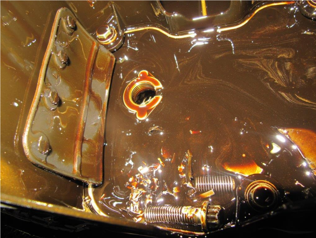
Bild 13: Gesammelte Werke in der Ölwanne. Das Öl schimmert goldfarben.
