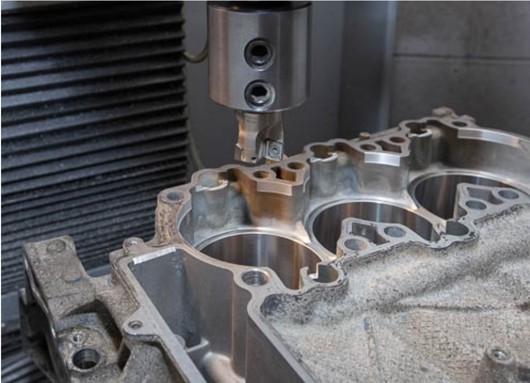
Bild 48a: Motorhälfte während der mechanischen Bearbeitung
