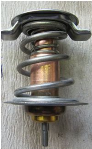
Bild 18: Das neue Niedrigtemperatur-Thermostat tut dem Motor gut
