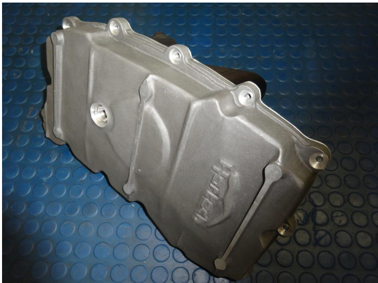
Bild 62: Die Racing-Ölwanne von unten. Hergestellt im Sandgussverfahren.
