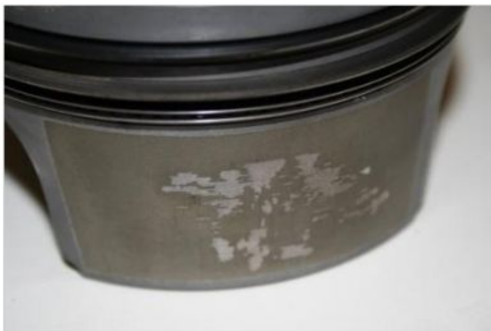
Bild 6: Teilweise beschädigte und partiell abgelöste Kolbenhemdbeschichtung
