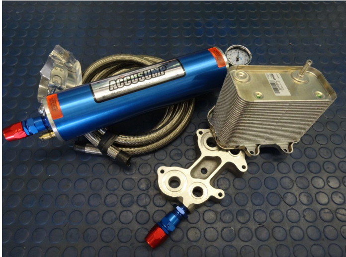
Bild 66: Das komplette Accusump-System ASPM96/7. Der Wärmetauscher rechts gehört nicht dazu.
