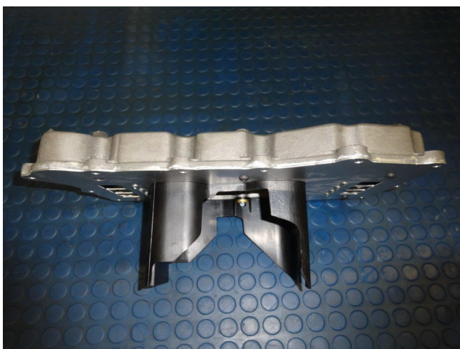
Bild 63: Die Racing-Ölwanne in der Seitenansicht
