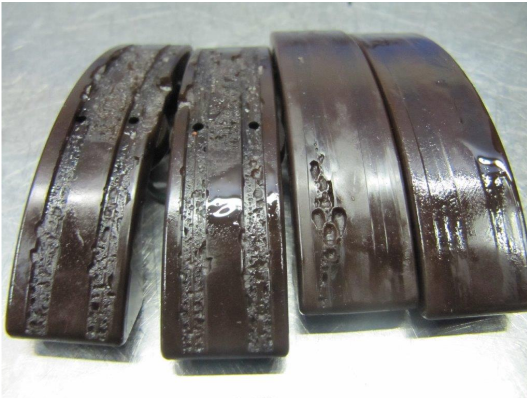
Bild 10: Total erodierte Kettenschienen
