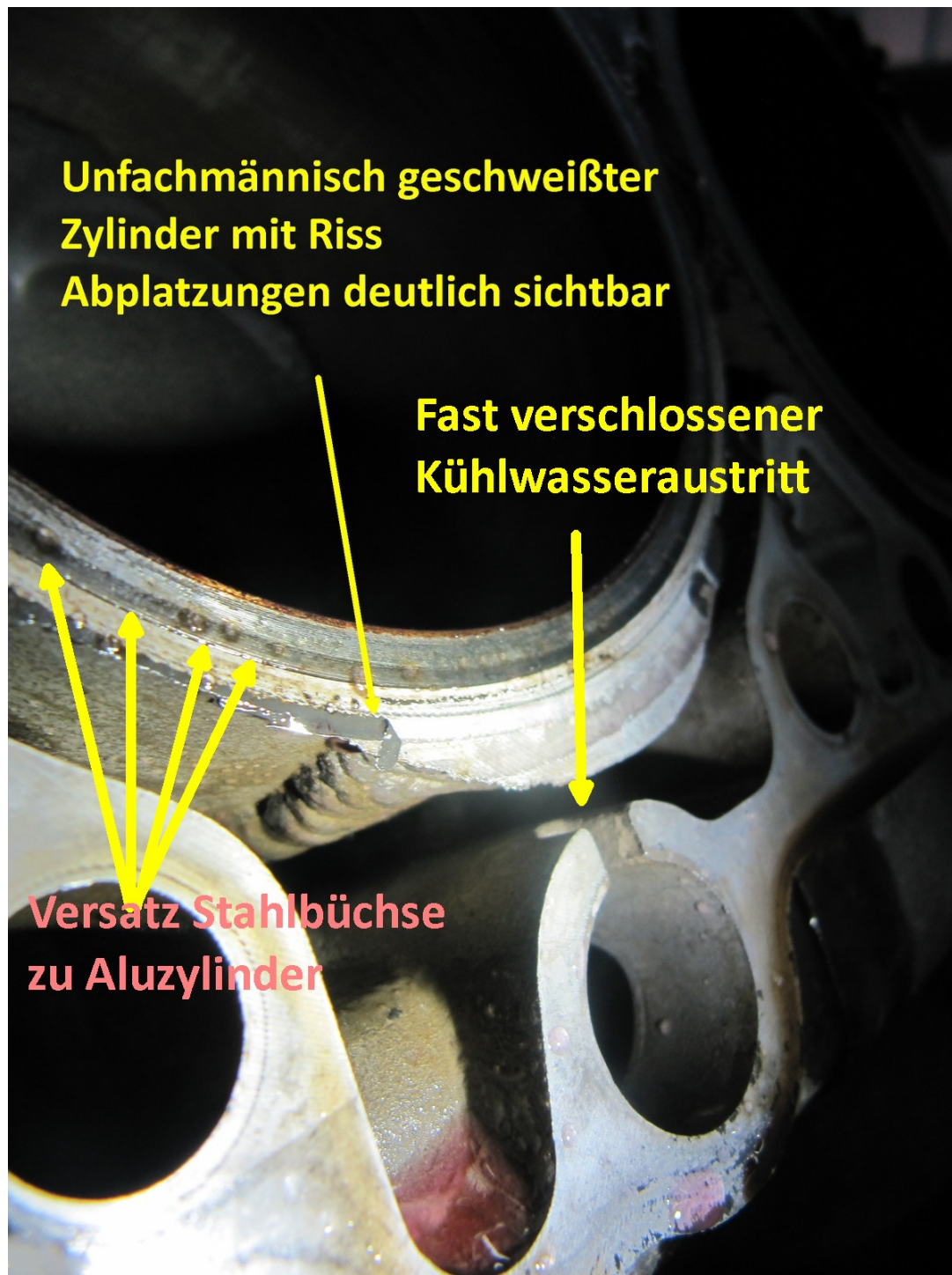
Bild 31: Detailaufnahme des Reparaturversuchs. Das soll Formel 1 Technologie sein? Damit wirbt wenigstens die Firma, die solche Motoren an Kunden ausliefert. Im Fahrbetrieb platze ein Stück der Schweißraupe ab. Wie bei allen Stahlbüchsen befinden Sie auch diese Stahlbüchsen nicht auf gleichem Niveau mit dem verbleibenden originalen Zylindermaterial aus Aluminium. Auch wurde durch das Aufschweißen der schmale Kühlwasserezulauf fast verschlossen. Diesen erweitern wir bei allen von Cartronic reparierten und optimierten Motoren. Mehr Fehler kann man nicht machen.
