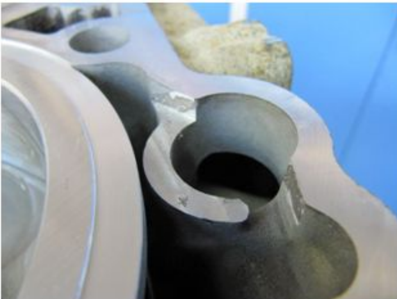
Bild 15: An die neue, ungünstig gestaltete Kopfdichtung angepasster und aufgefräster Kühlwasserkanal/Schlitz eines Versuchsmotors.
