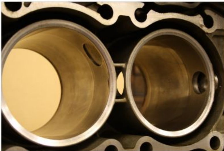
Bild 23: Erneuter Motorschaden durch eine sich gelöste und um rund 40° gegen den Uhrzeigersinn verdrehte „Stahl“-Zylinderlaufbuchse (links)
