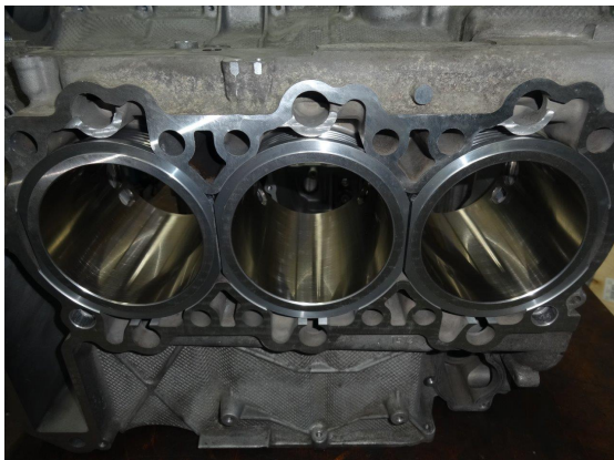
Abb. 70: Zum Vergleich die oberen Ringe nach Umbau auf „Closed-Deck“
