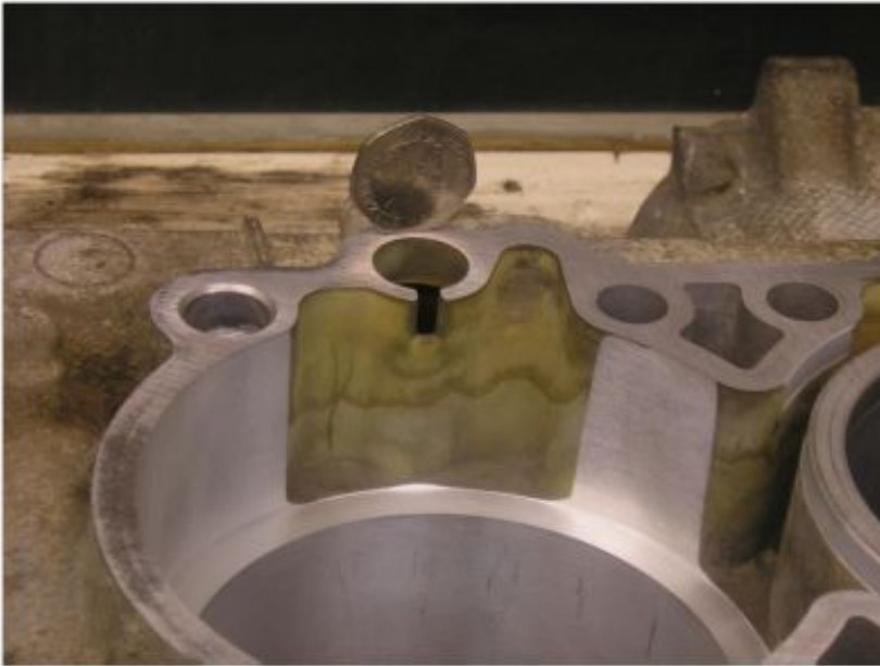
Bild 14: Der beschädigte Zylinder wurde bereits entfernt. Die Münze markiert die Position des noch nicht modifizierten Wasserkanals.
