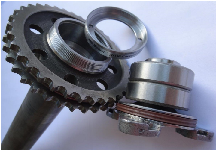
Bild 38: Der aufwändige Cartronic Doppellager-Kit Typ M.96/DB für Zwischenwelle M.96 (bis MJ 2000 ). Das „Lagerpaket“ wird durch eine Überwurfmutter gesichert. Das Wellenende verfügt über ein Außengewinde, die Ritzel sind nachträglich verstiftet und der Lagerdeckel wurde modifiziert. Der Lagersitz wurde nachgearbeitet. Diese Arbeiten sind nur im Hause Cartronic möglich.
