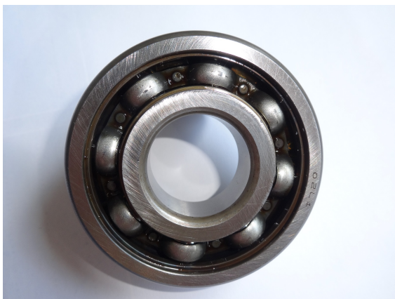
Bild 33: Zwischenwellenlager original - einreihig mit Stahlkäfig und 8 Kugeln, Lagerdeckel wurde nachträglich entfernt.
