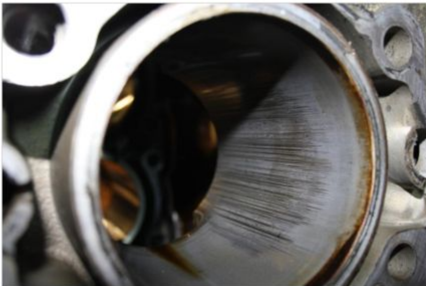
Bild 1: Zylinderlaufbahn mit typischen Fressspuren
