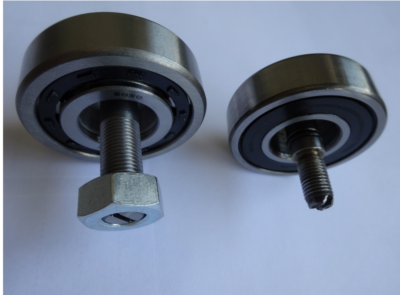
Bild 39: Cartronic Zwischenwellenlager-Kit einreihig (links) vs. Serie M.96 (ab MJ 2001-2006)
