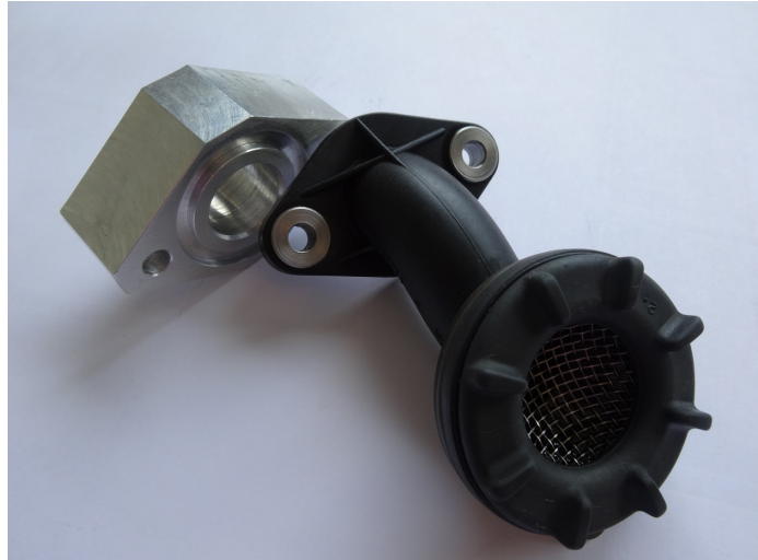
Bild 61: Der originale "Ansaugrüssel" der Ölpumpe mit dem 25mm hohen Distanzierungsadapter
