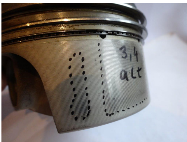
Bild 52: Kolben eines 3,4 ltr. Motors bei welchem die verschlissenen Kontaktflächen zu der Zylinderwandung markiert wurden. Das Kolbenhemd hat nur partiell getragen. Der Kontaktbereich (dunkler Bereich) beginnt erst 6 mm oberhalb der Kolbenunterkante. Der untere, nicht verschlissene Bereich steht im UT über die Unterkante des Zylinders über. Das gilt es zu verhindern.
