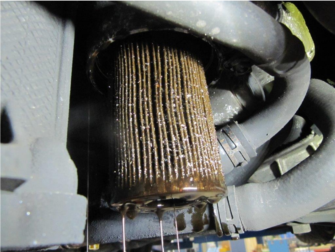
Bild 12: Metallspäne im Ölfilter
