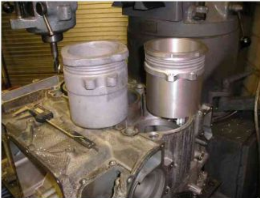
Bild 48: Zylinderrohling links und einbaufertiger mit Nikasil beschichteter Zylinder rechts
