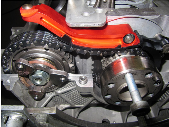
Bild 28: Verbaute Kettenschiene zwischen Kurbelwelle und Zwischenwelle
