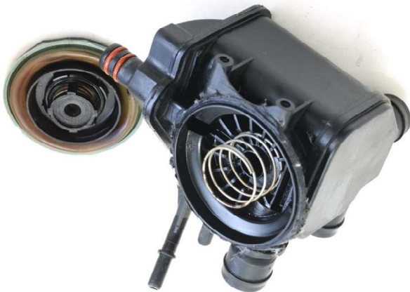
Bild 57: Geöffneter Separator (Ölabscheider)
