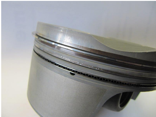
Bild 10: Zeigt die unbelastete Flanke (Kolbenhemd) von Kolben 4. Die seitliche Gleitschicht ist nahezu unbeschädigt. Aber der Bereich oberhalb des 1. Kolbenrings (glänzend) zeigt Abnutzungsspuren. Dort hat der Kolben die Lauffläche berührt (was nicht vorgesehen ist).
