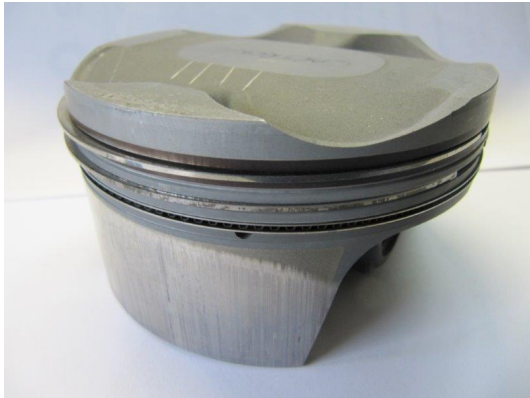
Bild 8: Zeigt das verschlissene, konische gewordene Kolbenhemd eines Kolbens von Zyl. 4. Im silbernen Bereich fehlen, von oben nach unten zunehmend, fast 1,0 mm Material, welches sich fein verteilt im Öl befindet. Ein derart beschädigter Kolben kontaminiert das Öl mit rund 150 mm 3 Aluminiumabrieb.
