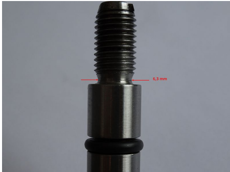
Bild 36: Zu schwach ausgelegter 10 mm Serien-Spannbolzen aller Zwischenwellenlager von 1996-2006 / Gewinde M8
