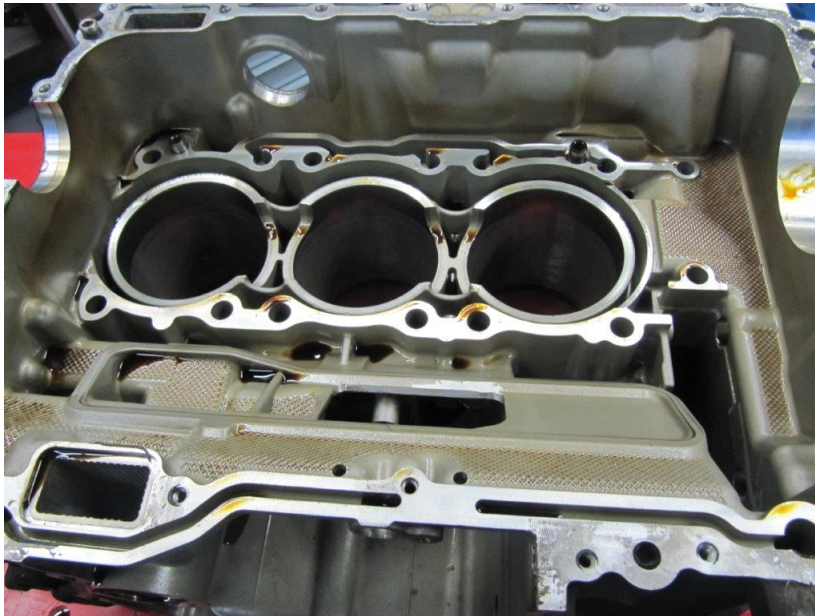
Bild 53: Originalmotor mit kurzen Zylindern. Die Aussparungen in den Zylindern zur Montage der Kolbenbolzen sind nach unten hin offen.
