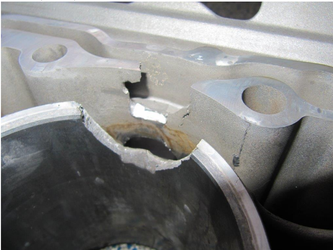
Bild 20: Pleuel trifft Zylinderwandung und Motorgehäuse
