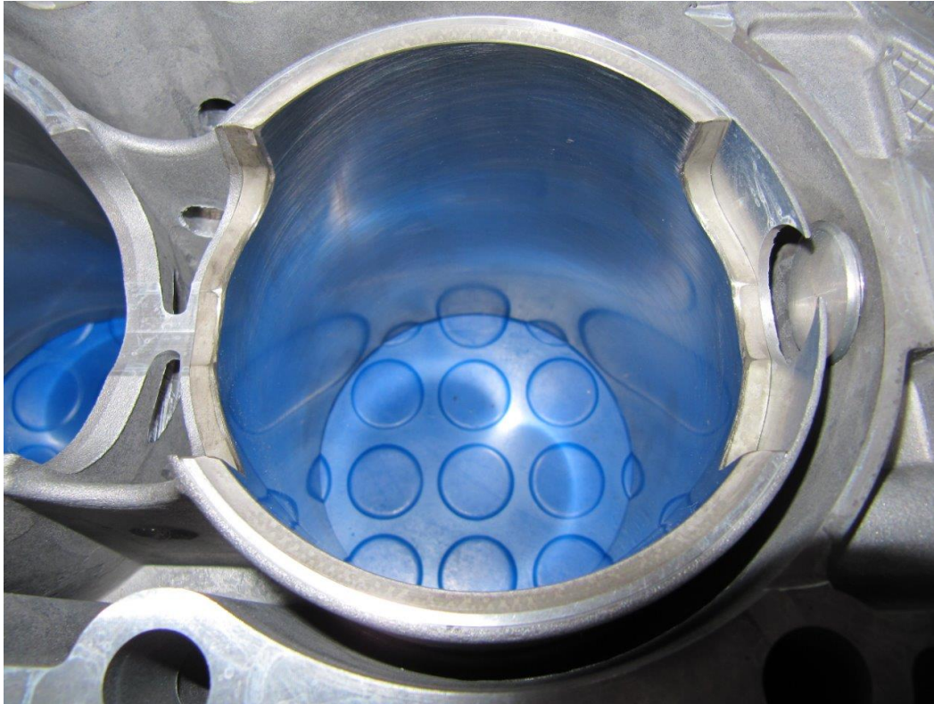
Bild 50: In das Gehäuse eingeschrumpfter, geschmiedeter und NiSiC-beschichteter Zylinder. (Ansicht von unten) Zylinder der Generation 2 sind 5,5mm länger.
