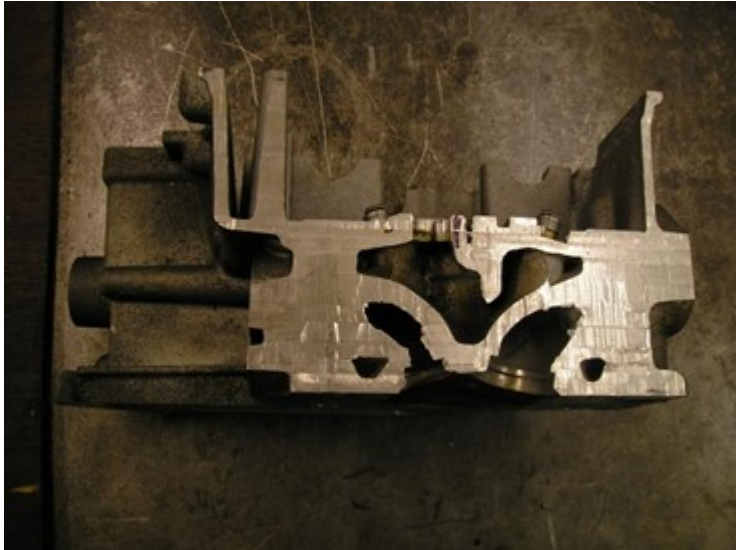
Bild 13: Querschnitt Zylinderkopf. Zeigt die Wasserkanäle
