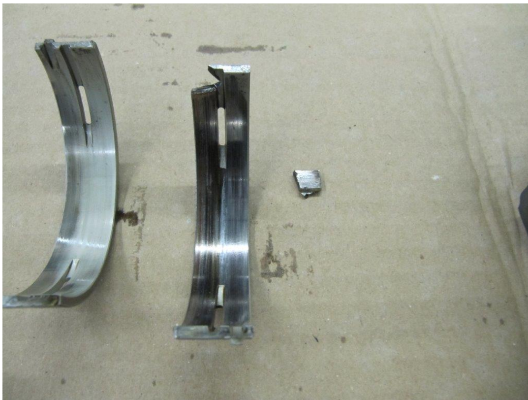
Bild 18: Beschädigte, teilweise blau angelaufene und geplatzte Lagerschale
