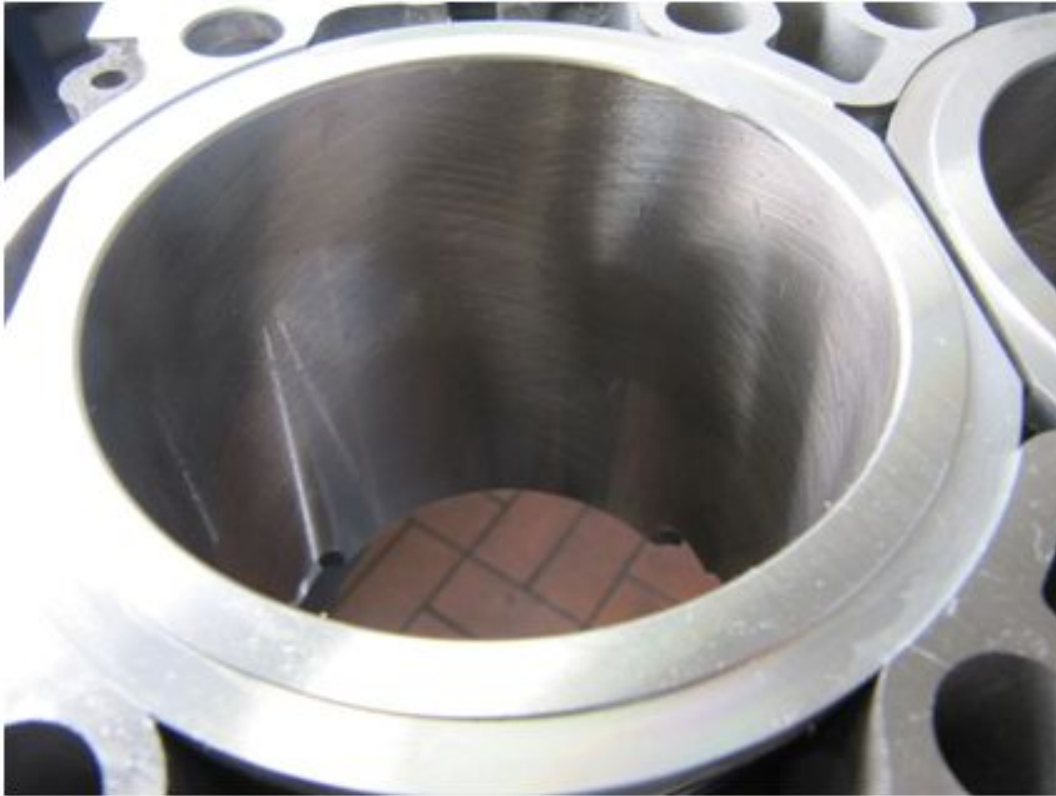
Bild 49: Von Cartronic eingebauter, fertig gehonter 3,8er Zylinder für einen 997 X51-Motor. Stabil, gut geführt, geschmiedet, NiSiC beschichtet. Gebaut für eine lange Lebensdauer.
