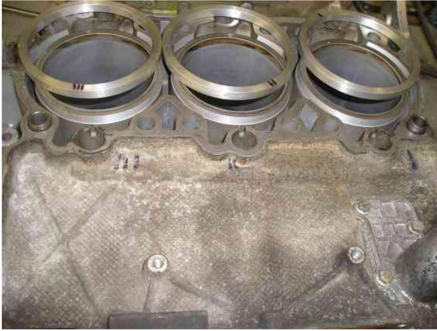
Bild 44: Unsere Verstärkungsringe, sichtbar und lose liegend am oberen Ende der Zylinder vor der Montage. Später befinden sich die Ringe direkt unter der Kopfdichtung und erzeugen einen Closed-Deck Motor.
