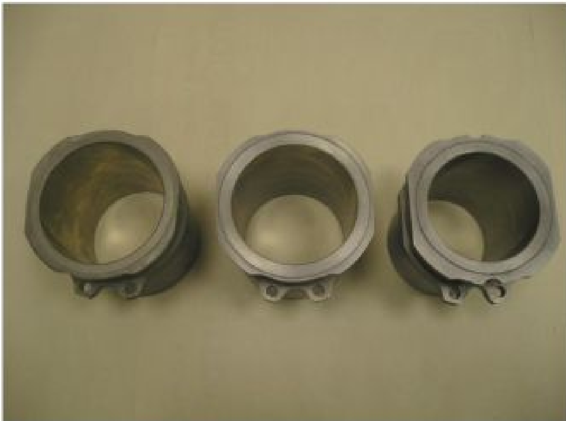
Bild 46: NISIC Zylinder verschiedener Bohrungen
