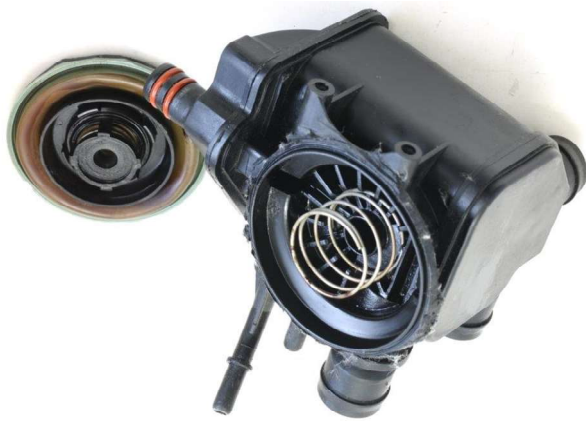
Bild 57: Geöffneter Separator (Ölabscheider)
