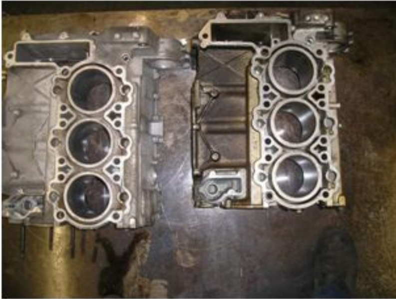
Bild 19: Oberseiten eines 3,2er Boxster S und eines 3,4er Motors in Open-Deck Konstruktion
