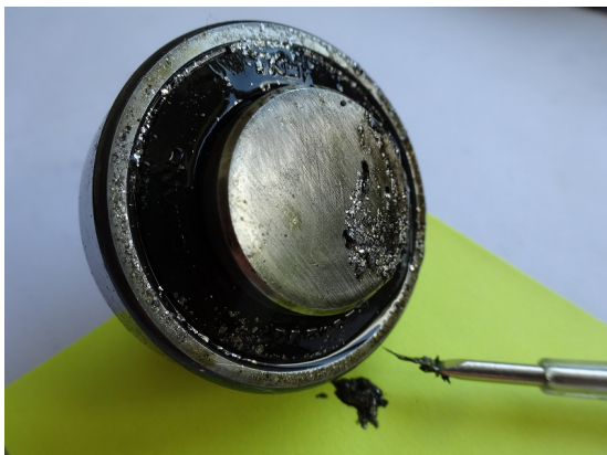
Bild 34 und 35: Defektes 996 Zwischenwellenlager mit Spänen (links - nach Ausbau, rechts - entfernter Deckel mit erkennbaren Metallfitter aus dem Inneren des Lagers)
