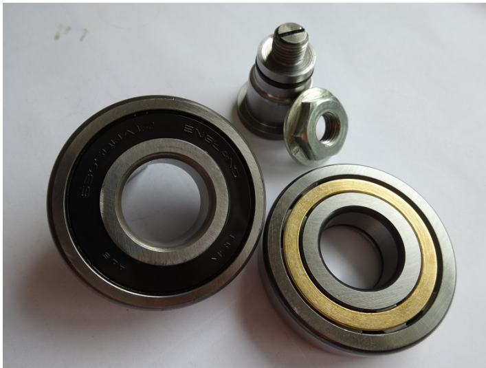
Bild 40: Cartronic Zwischenwellenlager-Kit "großes Lager" ab MJ 2007. Der massive Spannbolzen wird weiterverwendet. Links das Serienlager (geschlossen), Rechts das verstärkte und offene Speziallager mit Messingkäfig.
