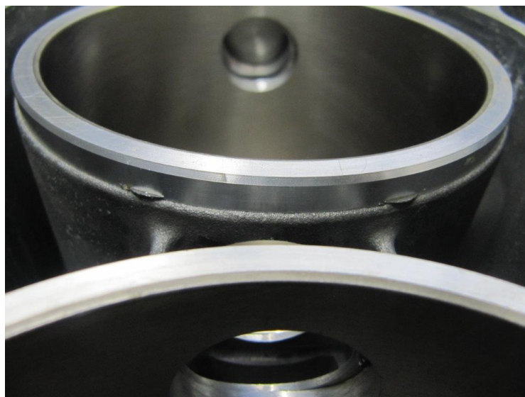
Bild 55 Eine vergleichbare Situation ergibt sich bei einem 3,4 ltr. Motor. Sichtbar sind die von uns eingebrachten, verlängerten aus geschmiedeten und mit NiSiC (Nickel/Silizium) galvanisch beschichteten Aluminiumzylinder der Generation 2.
