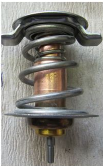
Bild 18: Das neue Niedrigtemperatur-Thermostat tut dem Motor gut
