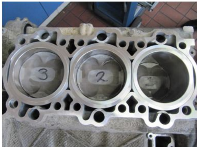
Bild 22: Ein von Cartronic Motorsport auf Closed-Deck modifizierter 3,8ltr. Motor mit NiSiC Zylindern.
