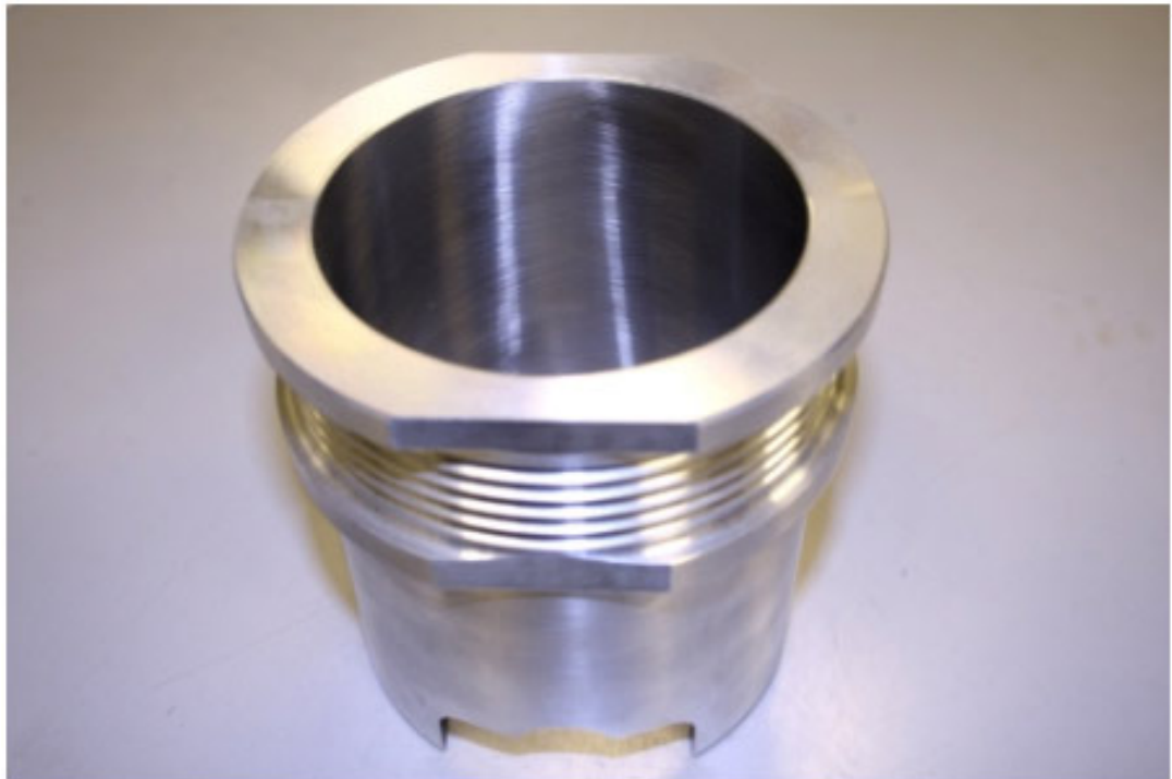
Bild 47: Gegossener (alte Version) und bearbeiteter NiSiC Aluminiumzylinder von Cartronic
