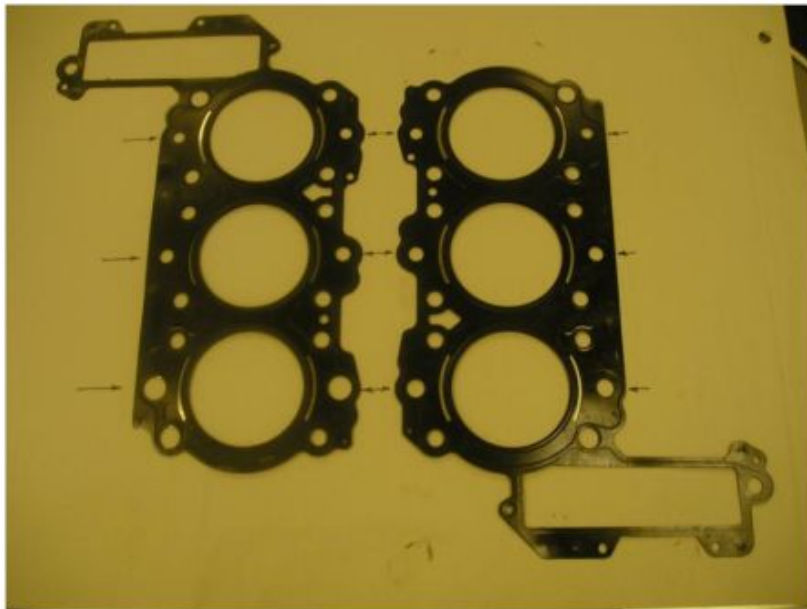
Bild 16: Bild der "alten", besseren und noch asymmetrisch aufgebauten Kopfdichtung
