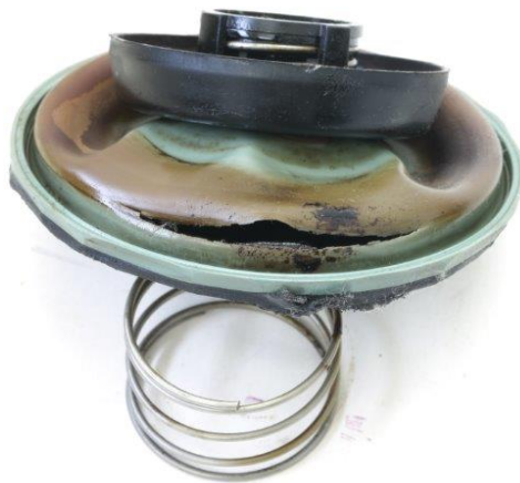
Bild 58: Deutlich sichtbar; die defekte Membrane
