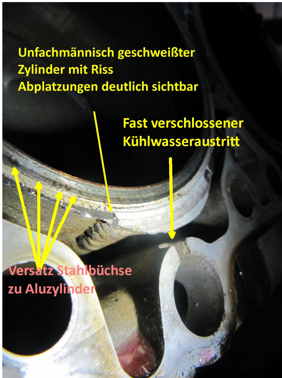
Bild 31: Detailaufnahme des Reparaturversuchs. Das soll Formel 1 Technologie sein? So schreibt es wenigstens die Firma, die solche Motoren an Kunden ausliefert. Im Fahrbetrieb platze ein Stück der Schweißraupe ab. Wie bei allen Stahlbüchsen befinden Sie auch diese Stahlbüchsen nicht auf gleichem Niveau mit dem verbleibenden originalen Zylindermaterial aus Aluminium. Auch wurde durch das Aufschweißen der schmale Kühlwasserzulauf fast verschlossen. Diesen erweitern wir bei allen von Cartronic reparierten und optimierten Motoren. Mehr Fehler kann man nicht machen.
