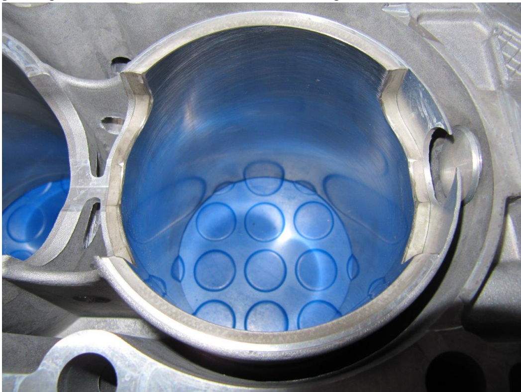
Bild 49: Von Cartronic eingebauter, fertig gehonter 3,8er Zylinder für einen 997 X51-Motor. Stabil, gut geführt, geschmiedet, NiSiC beschichtet. Gebaut für eine lange Lebensdauer.
