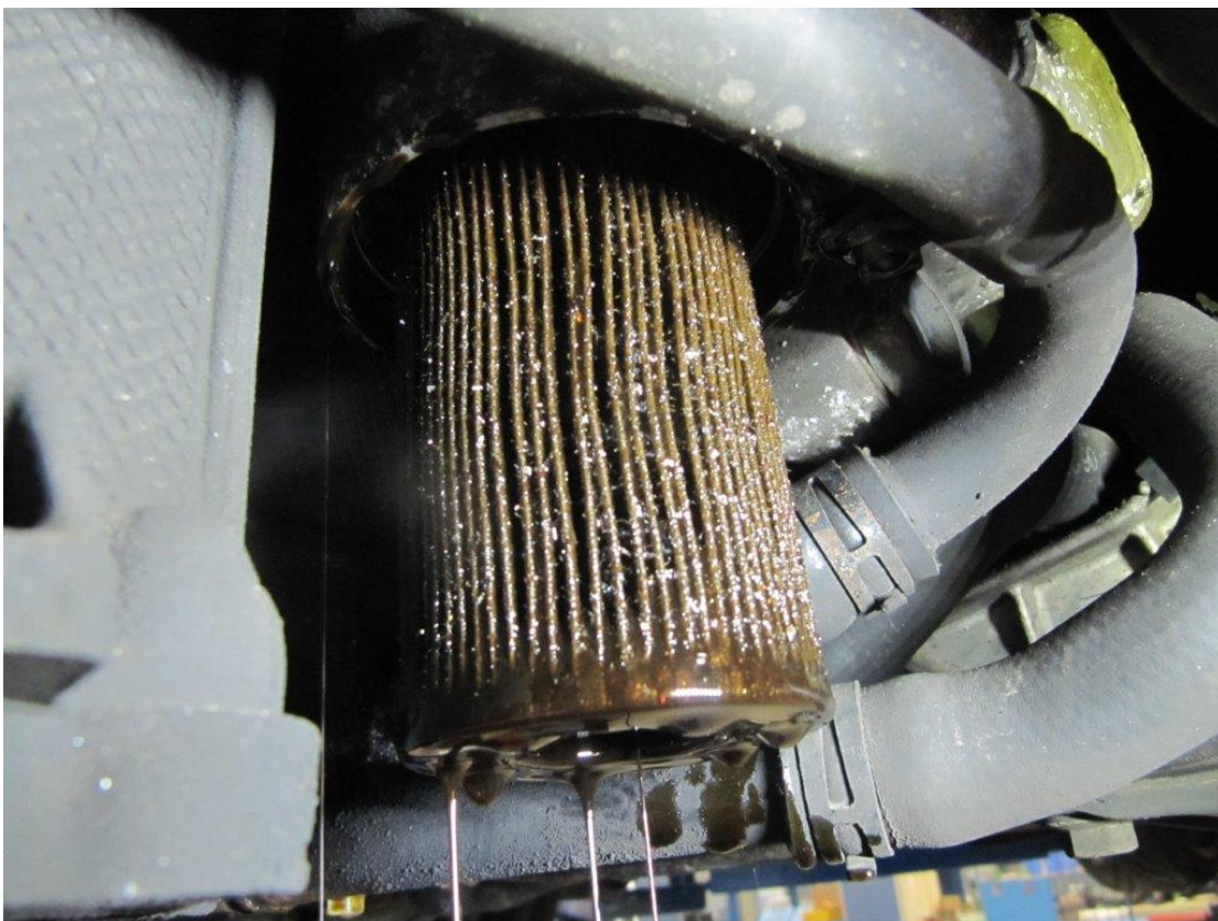
Bild 12: Metallspäne im Ölfilter
