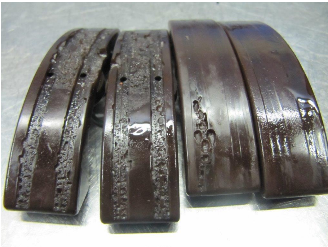
Bild 10: Total erodierte Kettenschienen
