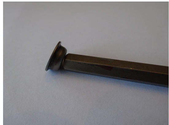
Bild 43: Der Anschlagdeckel und der Antriebszapfen im Detail
