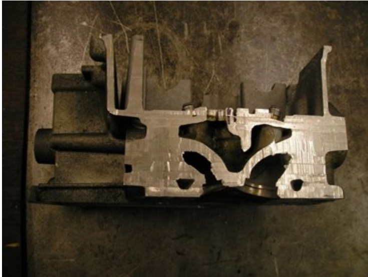
Bild 13: Querschnitt Zylinderkopf. Zeigt die Wasserkannäle
