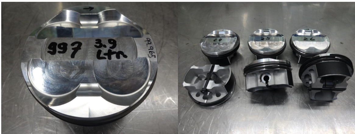
Abb. 71/72: Die Cartronic Spezialkolben für 3,7 ltr. und 3,9 ltr. Umbauten
