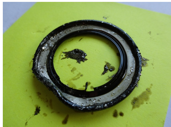
Bild 34 und 35: Defektes 996 Zwischenwellenlager mit Spänen (links - nach Ausbau, rechts - entfernter Deckel mit erkennbaren Metallfitter aus dem Inneren des Lagers)
