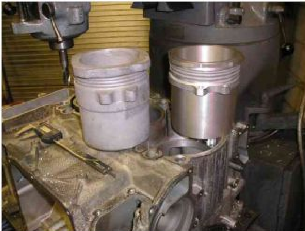
Bild 48: Zylinderrohling links und einbaufertiger mit NiSiC beschichteter Zylinder rechts
