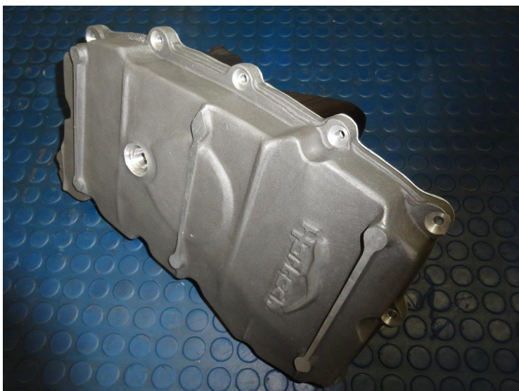
Bild 62: Die Racing-Ölwanne von unten. Hergestellt im Sandgussverfahren.
