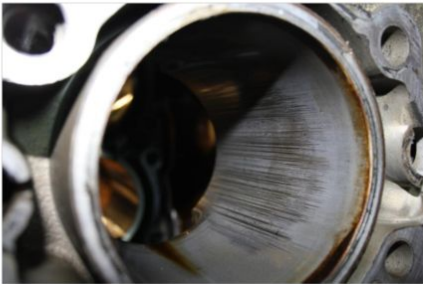
Bild 1: Zylinderlaufbahn mit typischen Fressspuren
