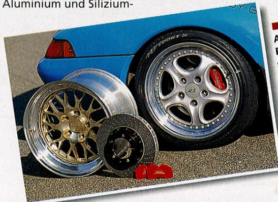
■ **Massentreffen:** Aluminium für Rad und Bremsscheibe von Advantec (links) helfen, erheblich Gewicht zu sparen
